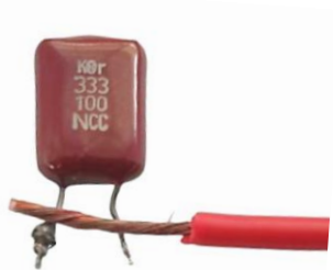
รูปที่ 3.18 วิธีทำการคายประจุของตัวเก็บประจุ ที่มา : จิรโรจน์ เลิศธนเปี่ยมสุขม, 2566
