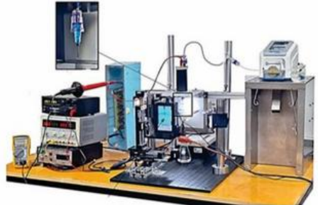
Figura 7. Montaje experimental para visualización del proceso de Electroatomización.
