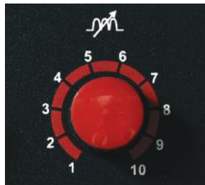
Rregullim kontinual i induksionit për tegel të përkryer saldimit
