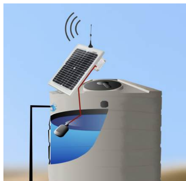
Transmisor en Extremo del Tanque
