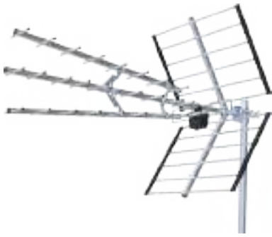
◀ Antena UHF TV 470-694 mhz Impedancia 75 ohm Longitud 1020mm 27 elemento Anti interferencias 9-15dbi Ref. 52024
