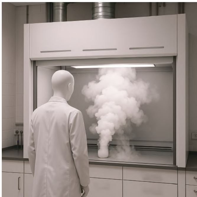
Obr. 2: Zkouška zadržení výparů pomocí stopovacího plynu
