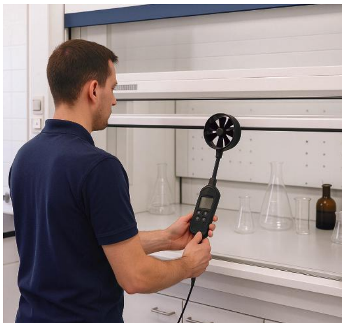
Obr. 1: Měření proudění vzduchu při otevřeném okně digestoře
