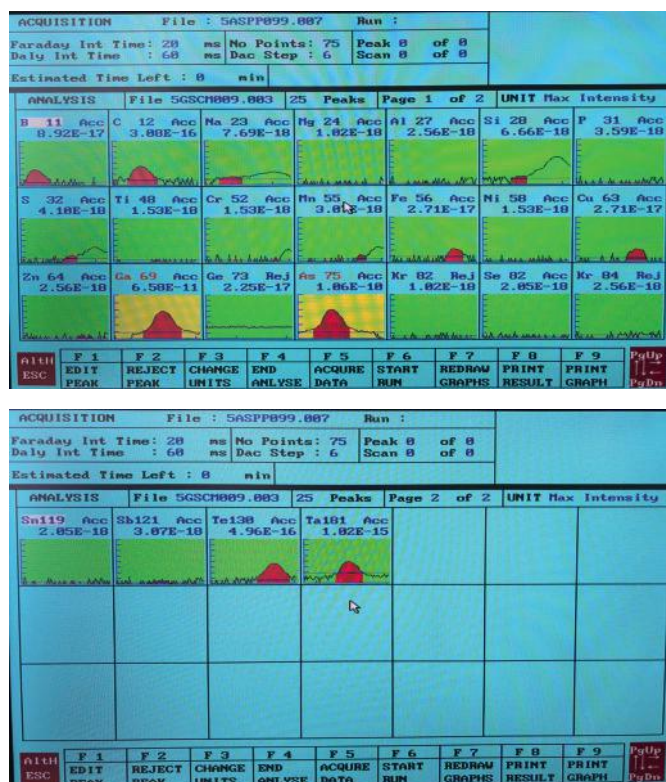
Obr. 5 a 6: Spektrum GaAs pre sledované nečistoty a dopant.
