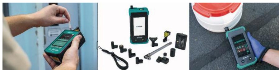
Obr. 2: MIRA XTR s pSERS substrátem, TacticID-1064 ST s vybavením a TacticID-1064 ST během „SeeThrough“ identifikace obsahu barelu.
