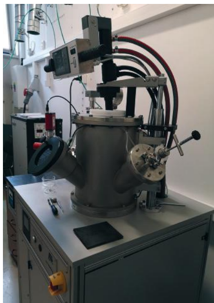
Obr. 1: Úspěšně nainstalovaná oblouková pec.
