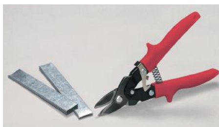
Mise en situation cisaille sur acier
