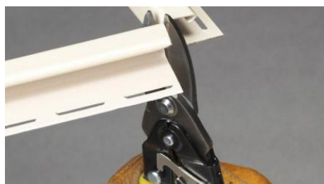
Mise en situation cisaille sur plastique
