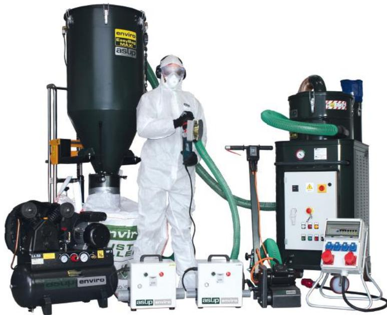
Geräteset für den Einsatz eines anerkannten emissionsarmen Verfahrens für Abbruch-, Sanierungs- und Instandhaltungsarbeiten an Asbestprodukten nach DGUV Information 201-012 (bisher BGI 664).
