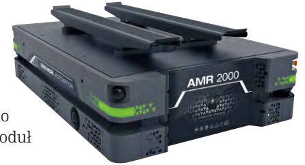
Platforma modułowa AMR 2000 została zaprojektowana z myślą o obsłudze palet materiałowych i wózków na wióry.
