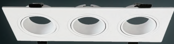
P2300B. Policarbonato. 3×GU10. 252×92mm. Orientable. Blanco.
