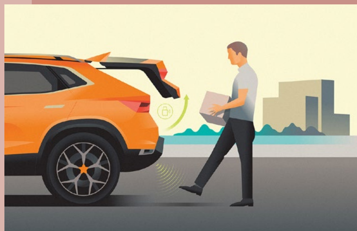
Hayon à ouverture et fermeture électrique avec «Virtual Pedal»
