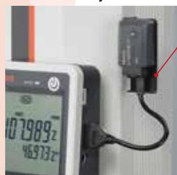
Para instalar **U-WAVE-T**, compre por separado la placa de montaje opcional (**02AZE990**).
