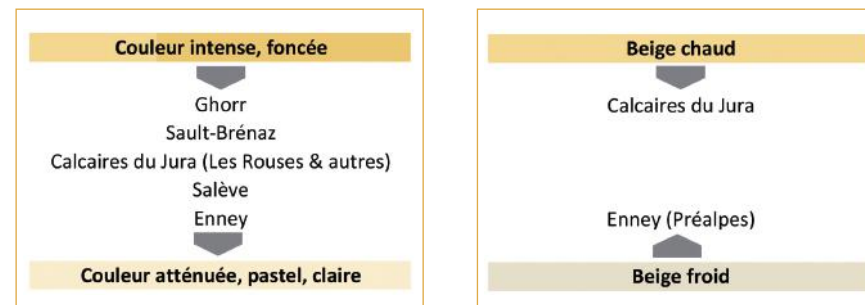
Fig. 30 et 31 – Évolution des couleurs des stabilisés naturels dans le temps.
