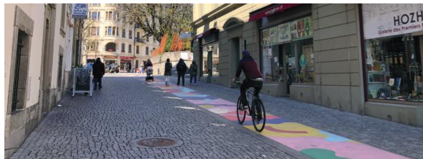
Pavés et boutisses grès en mélange, pose non liée, à l'antique, finition de surface poncé-flammé. Lausanne, Pré-du-Marché.
