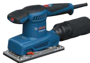
200 W. Velocidade regulável 8.000 - 12.000 rpm. Placa base 90-183 mm. Fixação da folha de lixa ou autoaderente por pinças ou contacto. 1,6 kg.
