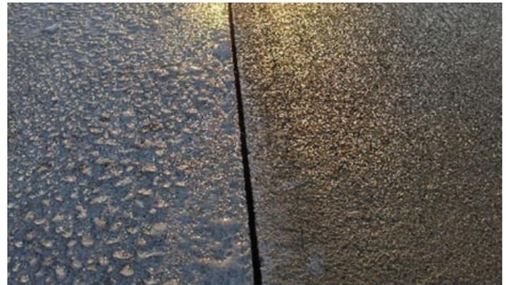
(Izquierda) Superficie de concreto húmeda tratada con sellador penetrante y (derecha) sin el sellador
