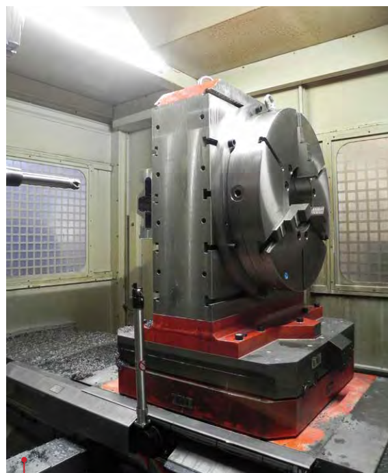
Precyzyjne, zmotoryzowane ramię zainstalowane na tokarce Trevisan.
