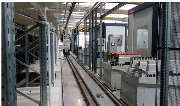
Maszyny Trevisan połączone w elastyczny system produkcyjny – FMS
