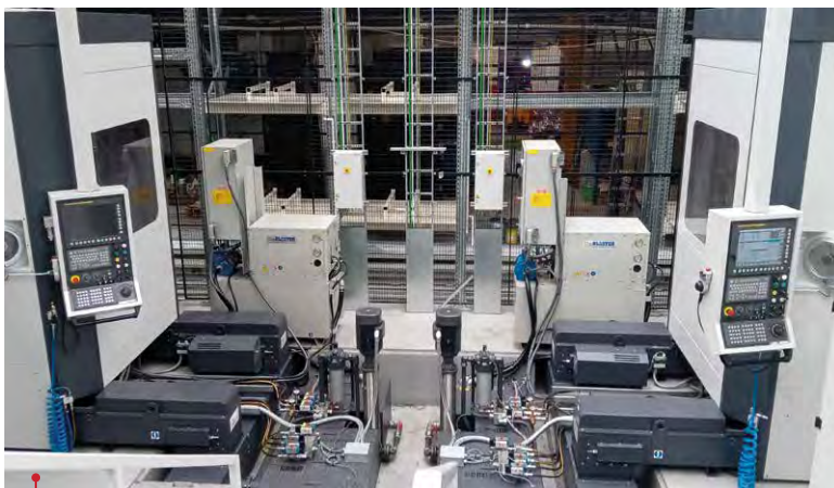
Linia produkcyjna w Trevisan - elastyczny system produkcyjny – FMS
