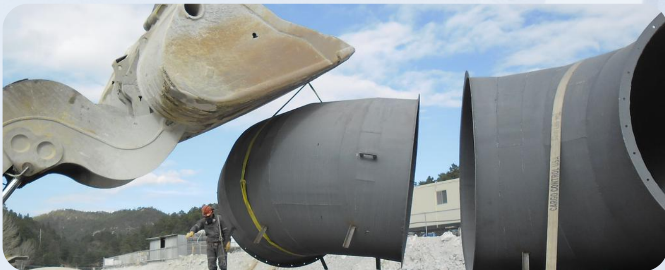
Ductos para ventilación en interior de minas
