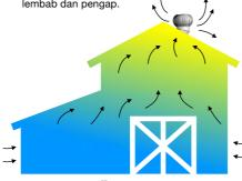
Dengan Mustaka Umil: Udara panas yang bertekanan merambat keatas hingga mampu menggerakan sirip2 turbine, udara panas yang dikeluarkan turbine ventilator digantikan udara segar kembali dari bawah ruangan, disamping mempertahankan suhu ruangan tetap sejuk juga menjaga kelembapan udara ruangan tetap kering.
