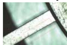
Detección de borde positivo con luz coaxial
