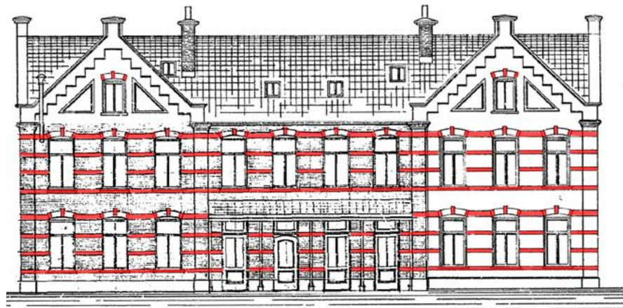
Voorgevel met daarin de neorenaissance elementen aangegeven
