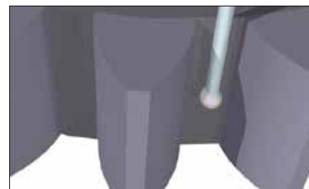
Medición de dientes de engranes microscópicos y perfil de forma de dientes/perfil de alineación de dientes
