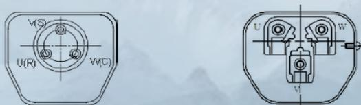
Tipo de terminales de pala Tipo de terminales de tornillo
