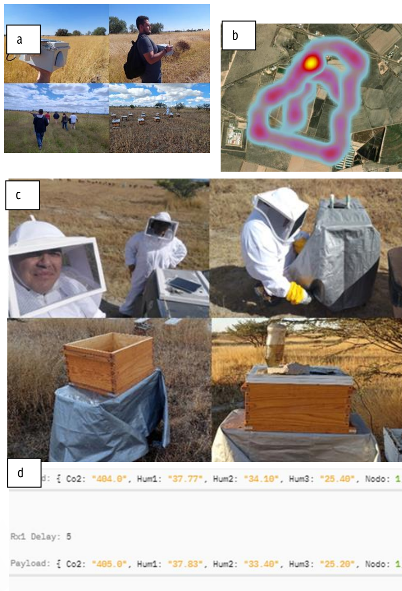
Figura 3. a), Verificación de la señal y pruebas de almacenamiento; b), Mapa RSSI sobre la cobertura de la señal; c), Instalación de la colmena experimental y d) Ejemplo de Raw Data enviado a la nube pública.
