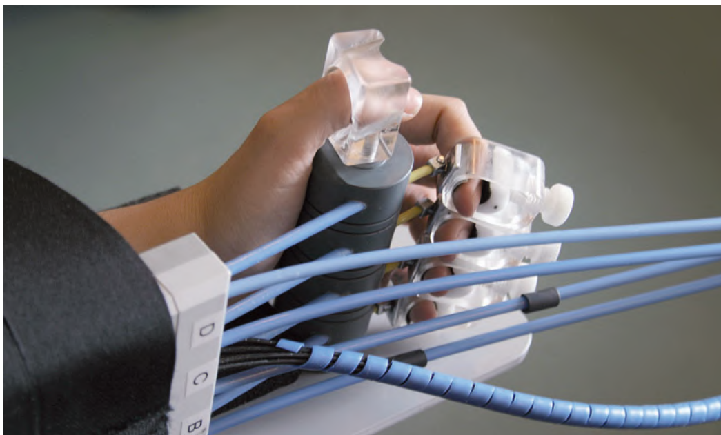
Ortosi robotiko honekin, mugitzeko asmoa kontrola daiteke, Tübingen Unibertsitatearen eta Fatronik Fundazioaren artean garatutako neuroprotesiari esker. ARG.: TÜBINGEN UNIBERTSITATEA.
