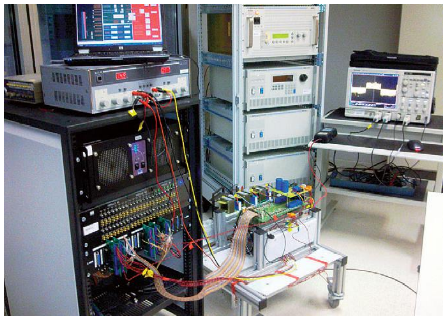
EHUKo APERT ikerketa-taldearen bihurgailu matritzial baten prototipatze azkarreko plataforma.
