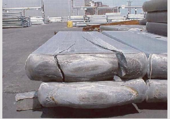
Döküm alüminyumda kalıntı gerilme kaynaklı çatlaklar (Courtesy of Alcoa Inc.)
