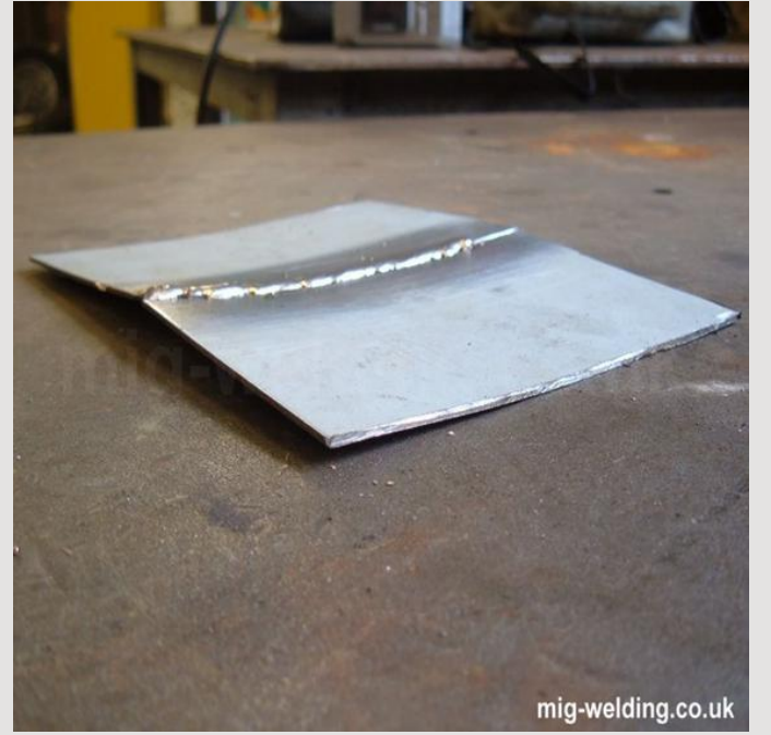
MIG kaynaklı çelik plakalarının deformasyonu (Courtesy of MIG-Welding UK)
