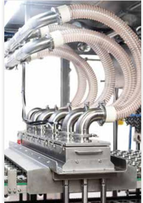
**Abb. 4: Eine weitere UV-Lampe desinfiziert die Siegelfolie für die Becherdeckel.**
