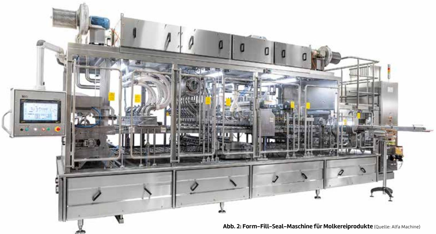
Abb. 2: Form-Fill-Seal-Maschine für Molkereiprodukte (Quelle: Alfa Machine)
