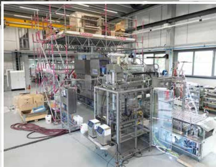
**10-bahniger Längsläufer GRUNWALD-FOODLINER 20.000 UC in der 6,5 m hohen Montagehalle 4 im Simulationsaufbau zur Beladung der Bechermagazine aus dem oberen Stockwerk des Kundengebäudes**
