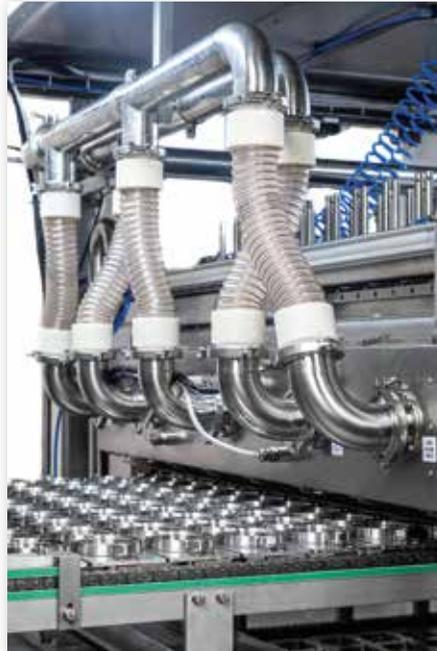
**Abb. 3: Zehn Joghurtbecher werden in 0,5 bis 1 s gleichzeitig desinfiziert (hier ohne Becher).**
