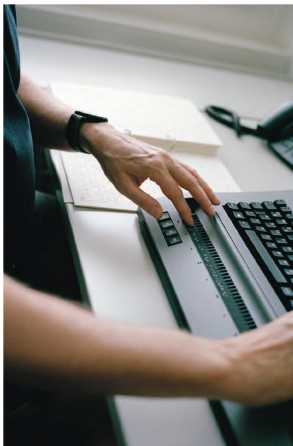
Links in Brailleschrift das Buch für die Abschlusskorrektur. Thomas Moser liest die Zeichen mit dem Finger und korrigiert sie am Computer mithilfe einer Braille-Zeile.
