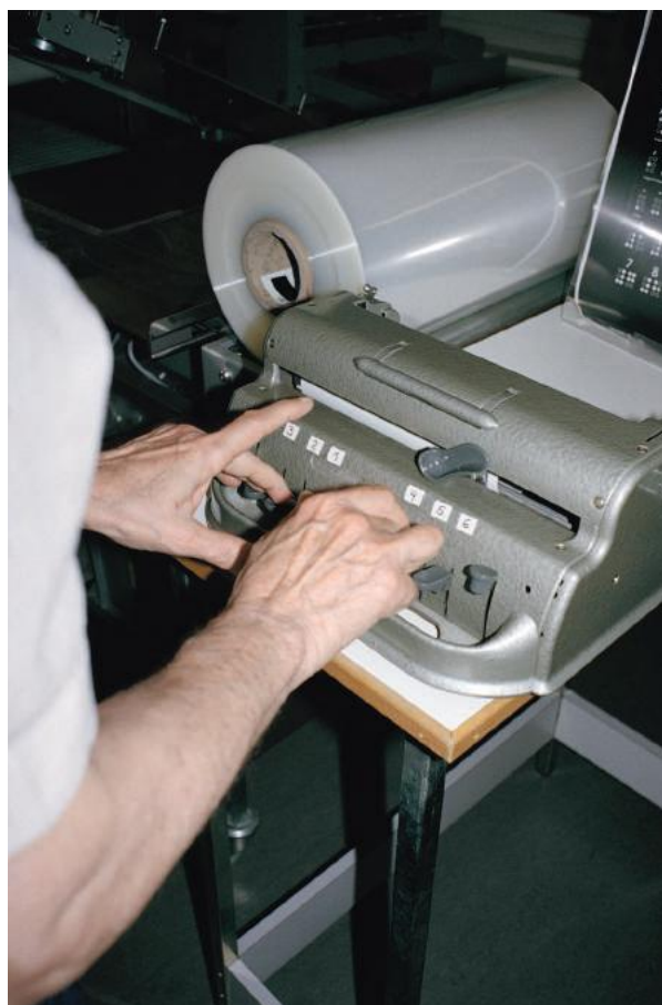
Die Perkins ist eine alte mechanische Schreibmaschine für Braille-Texte. Wie ein Kugelschreiber für Blinde, präzisiert René Moser bei der Demonstration.
