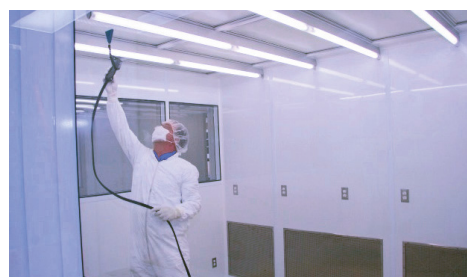
Photo : Contrôle manuel des particules
