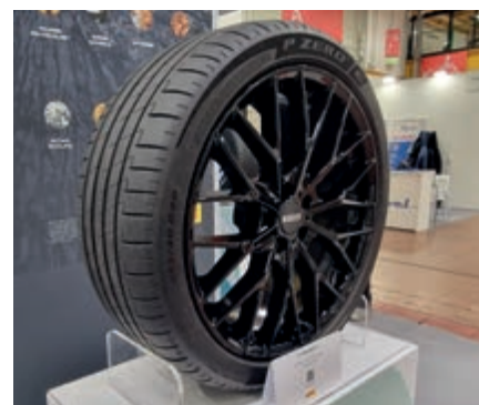
Pirelli P Zero E er designet til elbiler og er fremstillet af 55 % biobaserede og genanvendte materialer.
