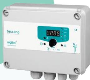
Commande 1 pompe monophasée, usages multiples. Commande avec ou sans sondes ou contrôleur de débit (flussostat). Entrée de commande externe. Report d'alarme, afficheur numérique, très convivial, réglage automatique de la protection thermique.
