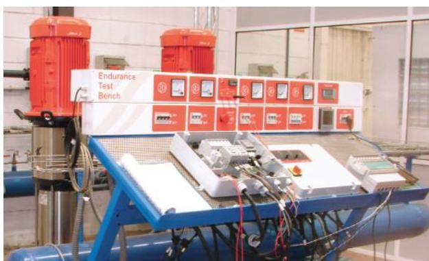
Banc d'essai hydraulique équipé de 7 pompes
