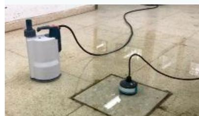
Enfichables directement sur la pompe pour le contrôle de niveau par sondes conductives ou flotteurs.
