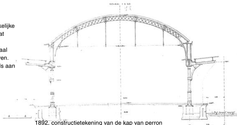
1892, constructietekening van de kap van perron 2/3. [RAN]
