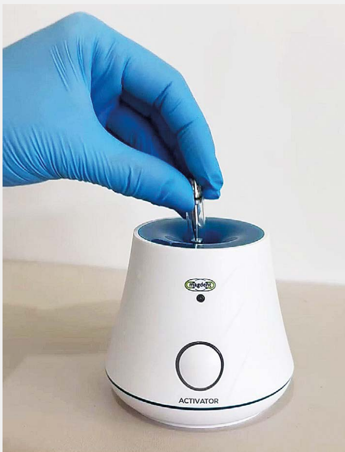
Dispositivo miniaturizado para estimulação eletromagnética do implante é ativado e aplicado de forma experimental nos animais
