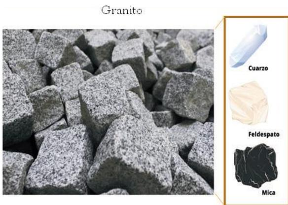
**Figura 3.** El granito, un ejemplo de material heterogéneo aleatorio.
