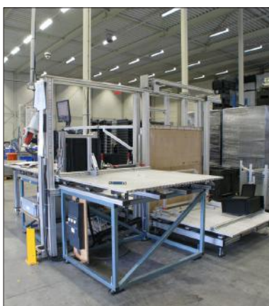
Machine à souder au miroir pour le soudage de produits plastiques jusqu'à 1200 mm.
