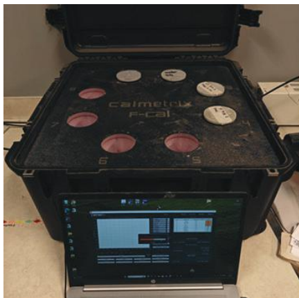
Fig. 3: a) Calorímetro semi-adiabático portátil, y b) ejemplo de perfil térmico de dos cementos.
