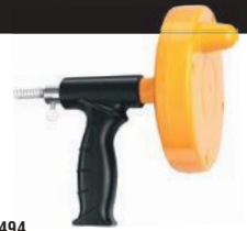
9716494 CON TAMBOR. Para desagües domésticos pequeños o medianos. Alambre de acero de resorte resistente a la oxidación, varilla equipada con punta en espiral, Recipiente de plástico auto almacenable con mango giratorio. Empuñadura de pistola ergonómica para mayor comodidad Cubierta del tambor de plástico. 6 mm.
