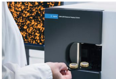
Obr. 1: Automatizovaný systém Agilent 8700 LDIR umožňuje vysokorychlostní rutinní analýzu mikroplastů a poskytuje informace o počtu částic, jejich velikostní distribuci a chemickém složení.
