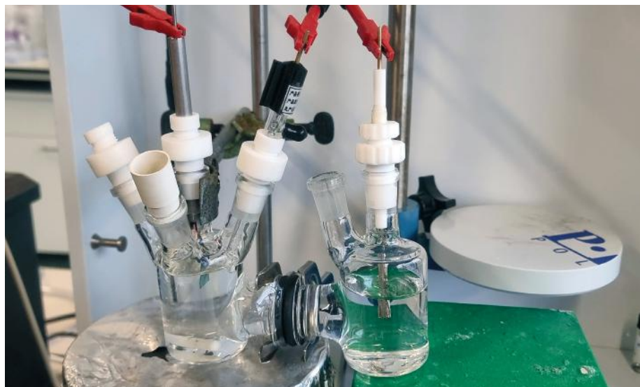
Obr.: Elektrolyzní aparatura k výrobě formiátu z glycerolu. (Foto: Tobias Rios-Studer)
