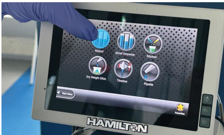
Obr. 3: Detail obrazovky pro systém Hamilton MicroLab 700. Vysvětlení režimů použití najdete v katalogu – viz QR kód na konci článku.
