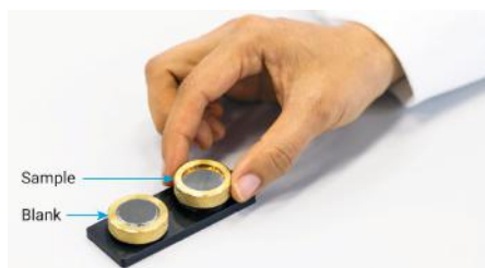
Obr. 2: Držák filtrů systému Agilent 8700 LDIR se dvěma pozicemi umožňuje sekvenci analýzy procesního slepého vzorku a vlastního vzorku za identických podmínek, čímž zajišťuje robustní kontrolu kvality analýzy mikroplastů.
