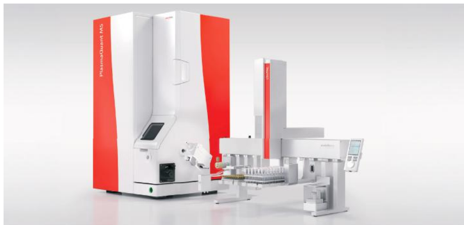
Obr.: clinPAL – první plně automatizované řešení pro manipulaci se vzorky pro ICP-MS.
