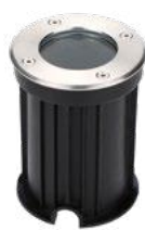
Oprawa najazdowa / Driveway fixture INGRESS 1xGU10 IP67 LED2B okrągła / circle | IP67 | 1xGU10 | wymiały / size: 10,8 x 10,8 x 13,5 cm 002242 | EAN: 5902201373752
