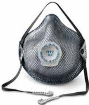
Facciale filtrante con adattamento automatico al viso Activform, struttura a rete Duramesh che mantiene la forma del respiratore e valvola Ventex. Elastico regolabile per un comfort maggiore. Protegge da polveri, fumi e nebbie in concentrazioni fino a 12 volte il limite di esposizione sul posto di lavoro (TLV). Idonea in presenza di odori sgradevoli.
