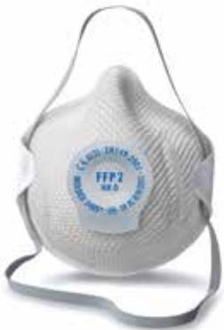
Facciale filtrante con adattamento automatico al viso Activform, struttura a rete Duramesh che mantiene la forma del respiratore e valvola Ventex. Elastico unico ad anello per un comfort maggiore. Protegge da polveri, fumi e nebbie in concentrazioni fino a 12 volte il limite di esposizione sul posto di lavoro (TLV).
