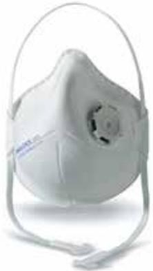
Facciale filtrante pieghevole con adattamento automatico al viso Activform, struttura a rete Duramesh che mantiene la forma del respiratore e valvola Ventex. Elastico regolabile per un comfort maggiore. Protegge da polveri, fumi e nebbie in concentrazioni fino a 12 volte il limite di esposizione sul posto di lavoro (TLV). Imbustata singolarmente.
