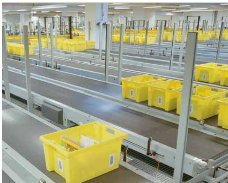
Bacs à fond renforcé sur un système de distribution pour l'e-fulfilment. (Photo : Vanderlande Industries)
