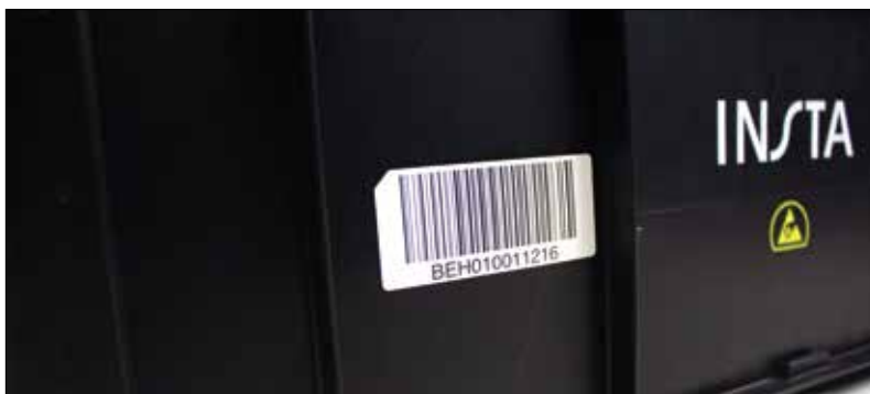
Un code-barres indétachable sur un bac grâce à la technique d'in-mould labelling.
