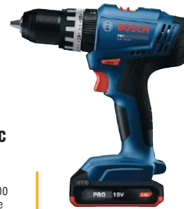
TALADRO/ATORORNILLADOR DE IMPACTO A BATERIA PRO GSB 18V-25 23029915 18V. Portabrocas metálico. 2 velocidades (0-400 / 1650 rpm). Máx. par de apriete 56 / 21 Nm. 0 - 24.000 ipm. Diámetro máx. de tornillo 10 mm. Luz LED. 1,2 Kg. 2 baterías x 2.0 Ah, cargador GAL 18V-40. Maletín de lona.
