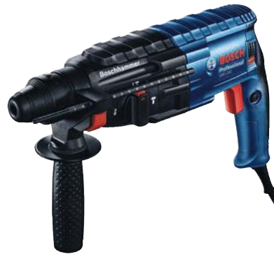
MARTILLO PERFORADOR GBH-240 23041111 790 W. 2,7 Julios. 0 - 4200 ipm. Portabrocas SDS-plus. Máx. perforación en hormigón: 24 mm. Velocidad variable. Giro reversible. Parada de giro para cincelar. Rótula en el cable. 2,8 kg. 5 brocas SDS plus-5X. Tope de profundidad. Empuñadura auxiliar Maletín.
