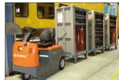
Versão com sistema de acoplamento. Usado na NedTrain para a prestação de serviços em comboios de passageiros. O conteúdo pode ser verificado através do plástico com leitores RFID.
