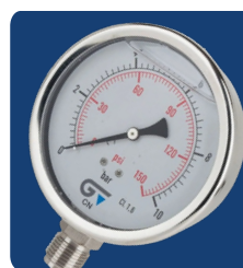
Manômetro DN100 - Total Inox - Glicerina - Vertical - BSP
