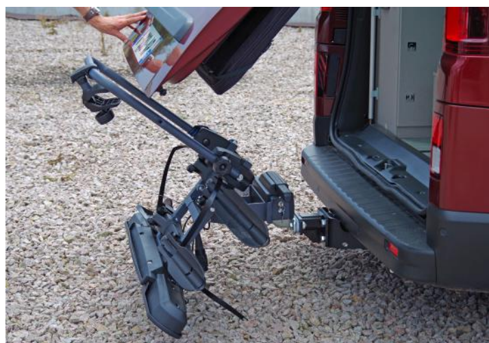
> Porte-vélos basculant pour libérer l'accès au coffre
