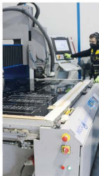
Centre d'usinage numérique pour plaques plastiques et métalliques
