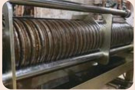
▲傳統的橫式榨油機 油餅整齊排放,慢慢的壓榨出滴滴好油
