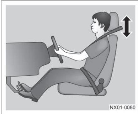
Ajuste la altura de los reposacabezas para que sus partes superiores estén a la altura del nivel de las cabezas de los pasajeros. Puede reducir el riesgo de lesión del cuello/la columna vertebral del pasajero en una colisión entre vehículos.
