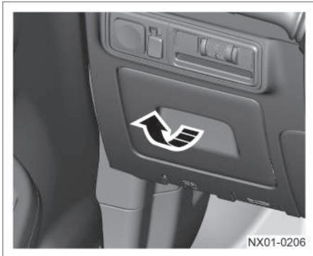
La caja de fusible del interior se encuentra a la izquierda del panel de instrumentos. Abra el compartimento de almacenamiento del panel de instrumentos para verificar los fusibles.
