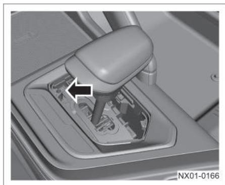
1. El botón de desbloqueo de emergencia de la palanca de cambio se encuentra en la parte inferior del panel de cambios.
