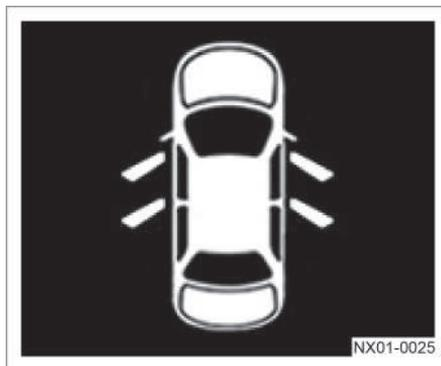
Cuando el vehículo está parado o la velocidad es inferior o igual a 10 km/h, si una de las cuatro puertas y el maletero se abre, la parte correspondiente mostrará el estado abierto. Cuando la velocidad es superior a 10 km/h, si cualquier puerta se abre, la parte correspondiente mostrará el estado abierto, el panel de instrumentos integrado emitirá una alarma sonora para advertir la puerta no cerrada.
