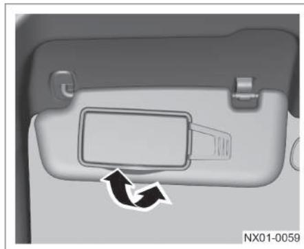
El vehículo está equipado con las viseras y los espejos de cortesía para el conductor y el copiloto. Voltee la visera, o tire de la visera del soporte y gírela hacia la puerta para reducir el deslumbramiento. Voltee la visera para utilizarla.
