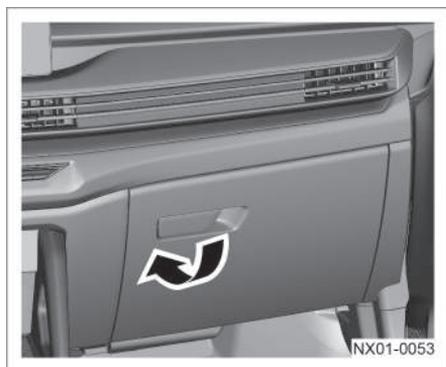
La guantera se encuentra en el lado del copiloto del panel de instrumentos. Tire la manija de la cubierta de la guantera hacia atrás para abrir la guantera. Empuje hacia adelante la cubierta de la guantera para cerrar la guantera.
