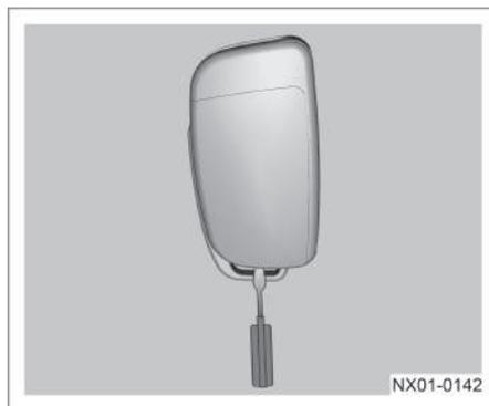
En caso de que la distancia del control remoto de su llave remota sea muy corta, falle el control remoto de vehículo, o bien el nivel de energía de la batería sea bajo, se deberá reemplazar la batería en la llave remota.
