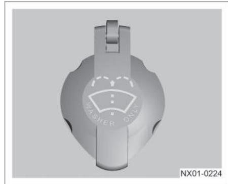
Abra el tapón de llenado con el símbolo de lavaparabrisas, y añada una cantidad adecuada del líquido de lavaparabrisas. Véase la sección “Compartimento del motor” en el capítulo para determinar la ubicación del depósito de líquido.
