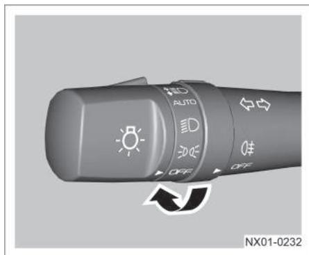
Dentro de los 10 minutos después de cambiar el interruptor de arranque a la posición OFF, cambie rápidamente el interruptor combinado de luces de la posición OFF a una otra posición, y vuelva a cambiarlo a la posición OFF, se activará la función sígueme a casa y se encenderán las luces de cruce.
