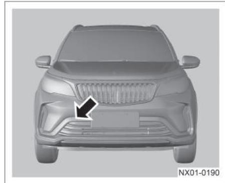
Para la instalación del anillo de tracción delantero, abra la tapa del remolque con manos, luego, atornille el anillo de tracción en el orificio de montaje, y asegúrese de que el anillo de tracción esté completamente apretado.
