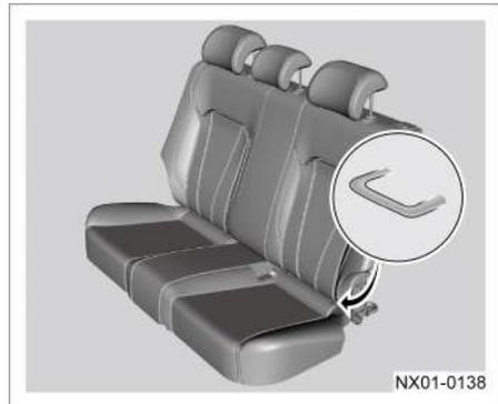
El dispositivo de seguridad infantil está instalado en los asientos traseros con este sistema especial de fijación que cumple con las especificaciones ISO. El sistema de fijación está instalado en la holgura entre el respaldo y la parte baja del asiento de las plazas traseras. El sistema de retención infantil, que cumple con la norma ISO, puede ser fijado por este sistema especial de fijación. En este caso, no necesita el cinturón de seguridad para fijar el sistema de retención infantil.
