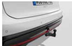
**Dispositif de remorquage d'origine Volkswagen**, y compris le kit électrique à 13 pôles, pour les véhicules sans préparation en usine.
