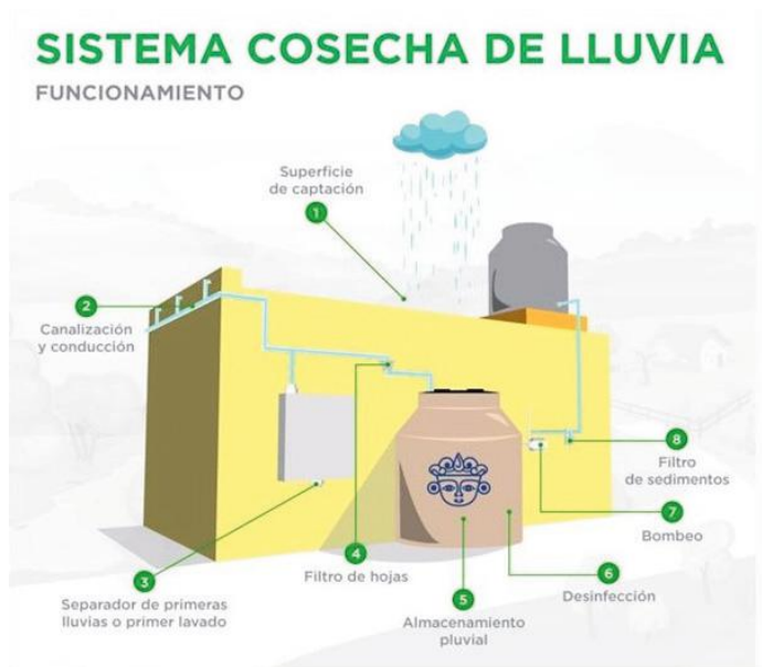
Figura 5. Sistema cosecha de lluvia.
